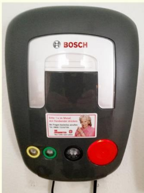
Hausnotruf- bzw. Sonderrufanlage
